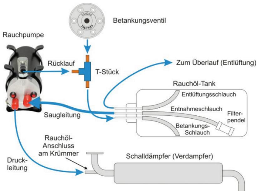
Die Saugleitung ist ein oft vernachlässigter Bereich. Bei einer möglichen Fördermenge von 740ml/min oder mehr darf die Saugleitung nicht beliebig lang sein. Entnehmen Sie die für Ihre gewünschte Fördermenge maximale Saugrohrlänge sowie minimalen Durchmesser aus der Tabelle 1. Beachten Sie, dass die Saugleitung im Tank in Form eines Pendels anfängt. Die Werte im Datenblatt beziehen sich auf die Gesamtlänge, es muss also auch die Pendellänge mitgerechnet werden.
