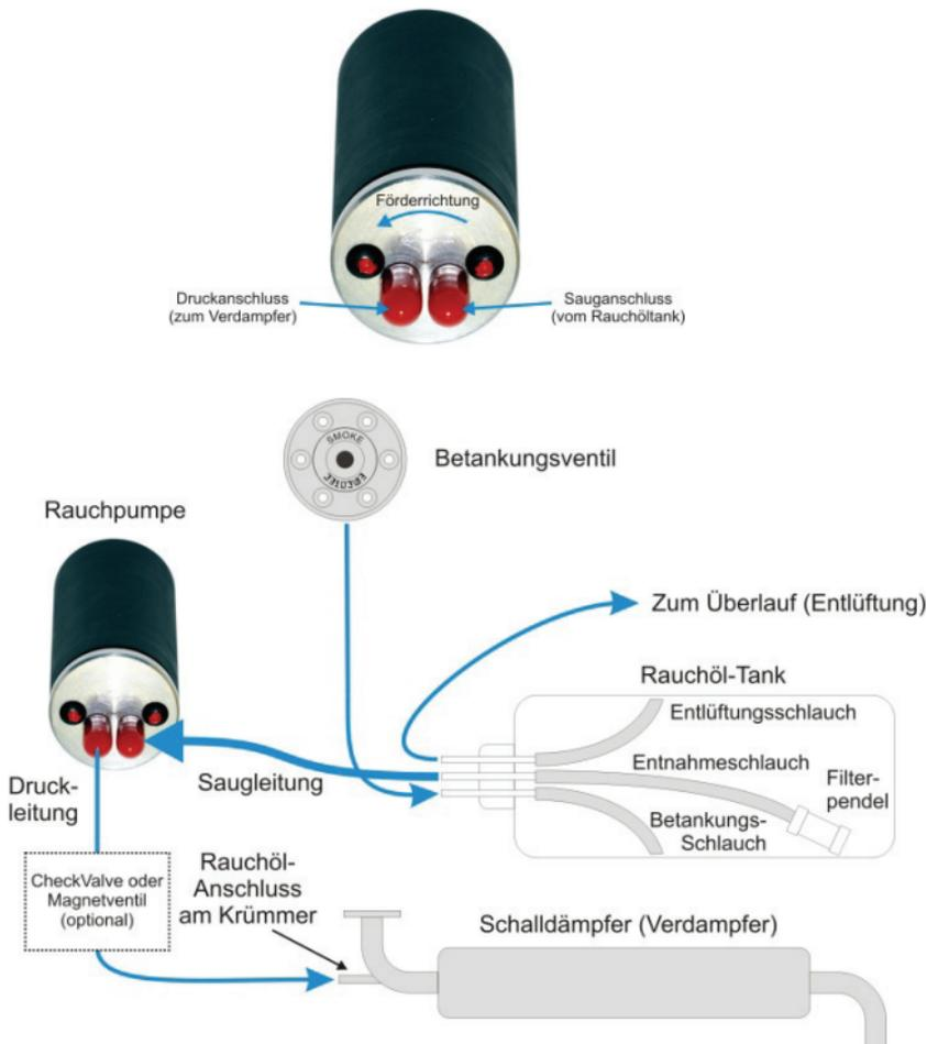
Die **PowerSmoke 740 HV** verfügt über ein integriertes Ventil und kann daher auch unterhalb des Tankniveaus platziert werden.
